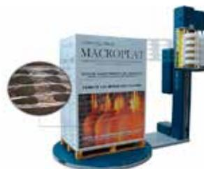
Fabricación y aplicación de film MACROPACK integrado en la misma máquina.
