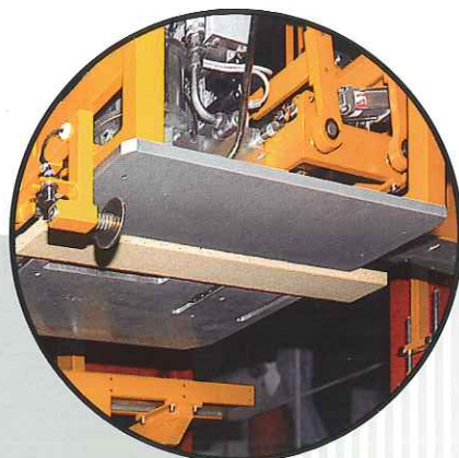
DISPOSITIVO AUTOMÁTICO PARA LA INTRODUCCIÓN DE TACOS INFERIORES
