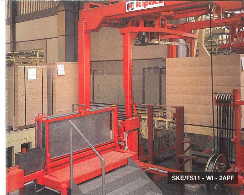
Pinza elevadora de listón del almacén y depósito para la aplicación superior
