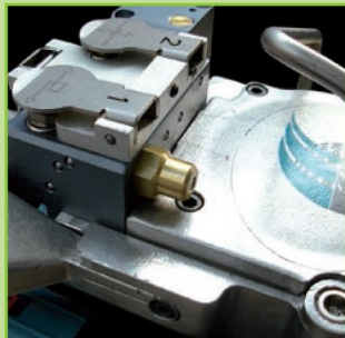
Nuevo indicador de tiempo enfriamiento soldadura
